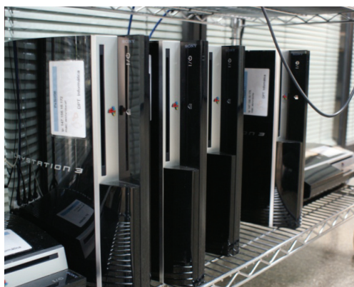
Figura 2. Detalle del Clúster de PS3 de la Universitat de València
