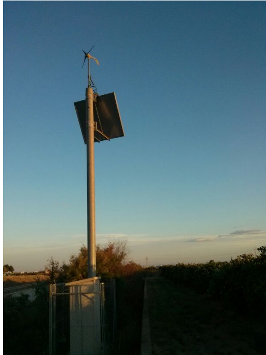
Figura 3.5: Estación autónoma que se abastece mediante la combinación de un generador eólico y otro solar situada junto al barranco del Carraixet en el término de Vinalesa.
